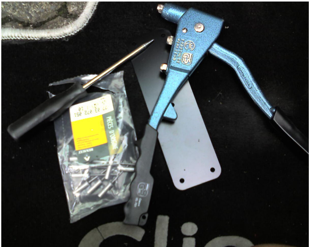
benötigtes Werkzeug: Blindnietzange und eine Ahle oder ein kleiner spitzer Schraubendreher
