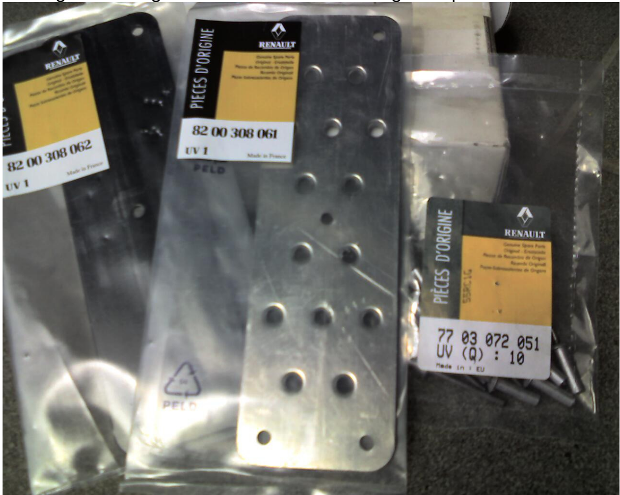
8200308062 Unterlage, 8200308061 Alustütze, 7703072051 Nieten
