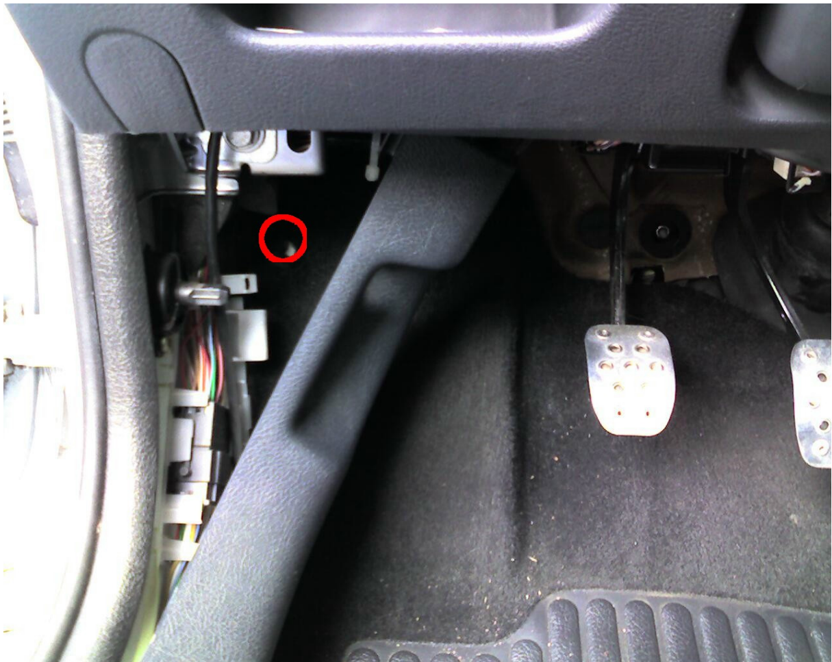
Kunststoffschraube (roter Kreis) aus Teppich drehen, Hebel für Motorhaubenentriegelung abhebeln, Verkleidung vorsichtig lösen. Teppich kann nun angehoben werden
