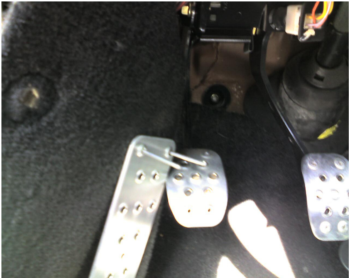
Aluplatte an gewünschte Position legen, mit Ahle Löcher durch Teppich stechen. Position der Platte dann gleich mit den Nieten fixieren.
